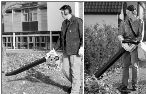
Рис. 9 Положение оператора при работе воздуходувным устройством
