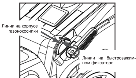
Рис. 2 Установка нижней части рабочей рукоятки
