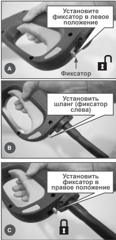
Рис. 3 Подключение шланга высокого давления к пистолету
