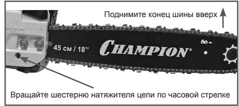
Рис. 5 Регулировка натяжения цепи
