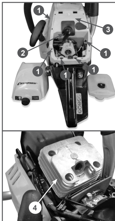
Рис. 23 Очистка охлаждающих ребер цилиндра
